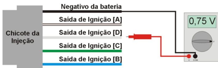
Medindo as saídas de ignição
